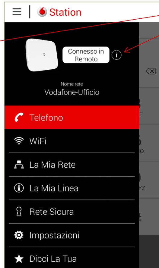
Sulla parte alta del menu è visibile lo stato della connessione tra app e Station (Connesso, Connesso da Remoto, Non connesso).
