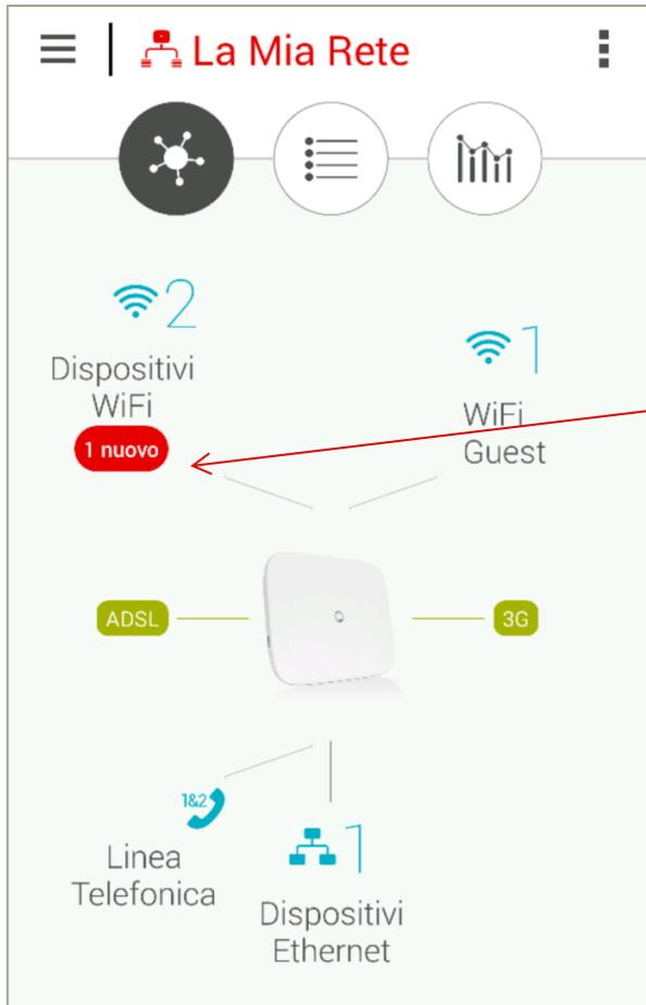
In questa sezione è possibile visualizzare la mappa della rete con il tipo di connessione (ADSL/ Fibra), i dispositivi connessi alla Station (tramite WiFi, Guest WiFi, Ethernet, USB), la/e linee telefoniche attive e la Internet Key se presente.
