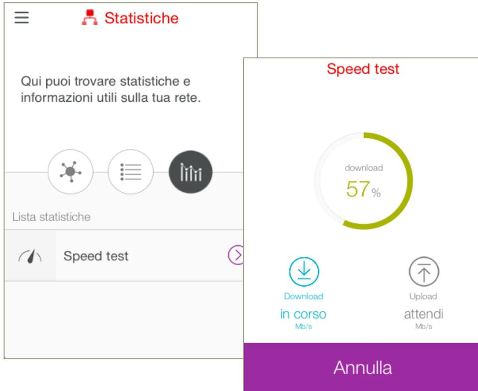
Cliccando su «statistiche» e' possibile accedere alla sezione dello speed test.
